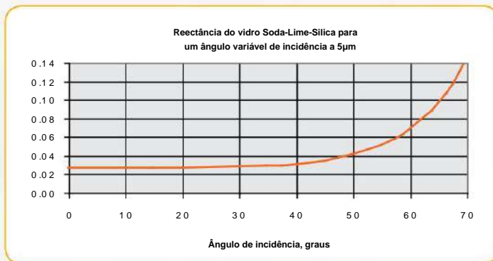
Figura 8. Refletância do vidro em função do ângulo de visão da câmera em relação à incidência normal
