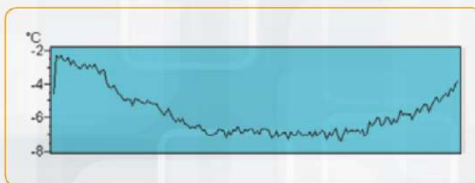
Figura 3. Gráfico de temperatura ao longo de uma área selecionada de um objeto alvo usando a função de perfil de uma câmera
