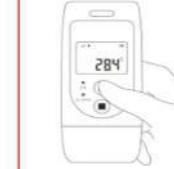
Pressione brevemente "►" para alternar para uma interface de exibição diferente. As interfaces mostradas em sequência são respectivamente:
