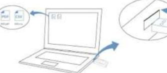
Após a gravação, conecte o dispositivo à porta USB do PC, ele gerará automaticamente o relatório PDF e CSV.
